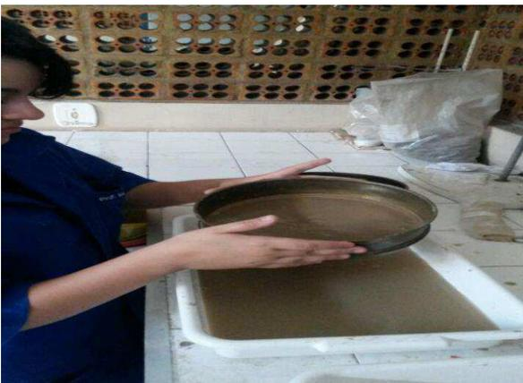
Imagem 31. Peneiramento a úmido. Fonte: TAPAJÓS. S.N. 2015
