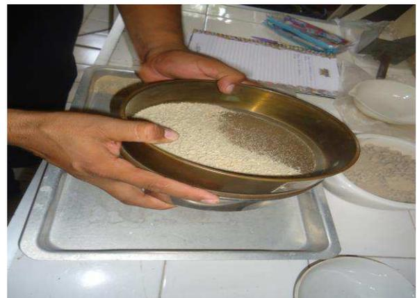
Imagem 26. Material de análise sendo peneirado. Fonte: MAGALHÃES. L.A.F. 2015
