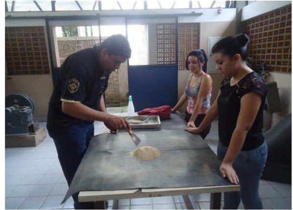
Imagem 28. Material de análise no formato de pilha para esquarteramento. Fonte: MAGALHÃES. L.A.F. 2015
