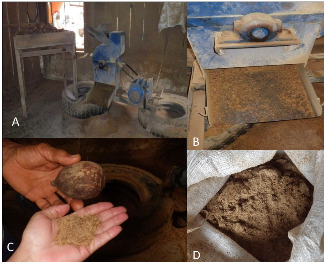
Figura 14 - (A, B) Máquina de triturar o côco babaçu, (C,D) côco babaçu antes e depois da trituração na máquina.
