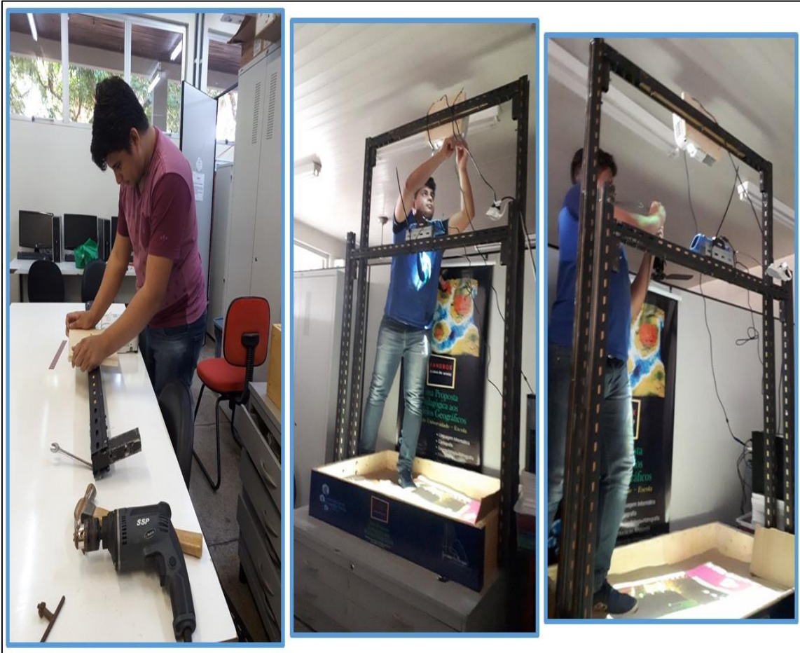
Figura 2 – Montagem dos Perfis Metálicos.
